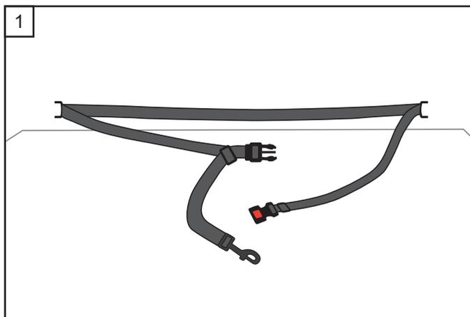
Öffne den Ringgurt und führe den Gurt durch die Gepäckösen in Deinem Kofferraum. Vielleicht musst Du dafür den Klickverschluss vom Gurt lösen, damit der Gurt durch die Ösen passt. Wenn Du keine Gepäckösen in Deinem Kofferraum hast, nutze die Einbauanleitung für Autositze & Rücksitzbank und lege den Gurt um die Rücksitzbank.
