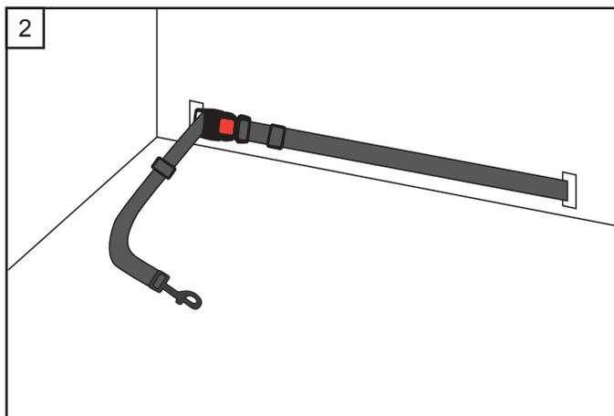
Führe nun beide Enden des Ringgurtes durch die vorgesehenen Schlitze und klicke den Verschluss zu. Der Verschluss sollte im hinteren Teil des DOGSTYLER® liegen. Zieh anschließend den Gurt stramm. Den übrigen Rest des Gurtes kannst Du durch den Schlitz zurück führen. Dann verschwindet er hinter dem DOGSTYLER®. Wenn Du den Gurt um die Rücksitzbank gelegt hast, nutze die hinteren Schlitze rechts und links.
